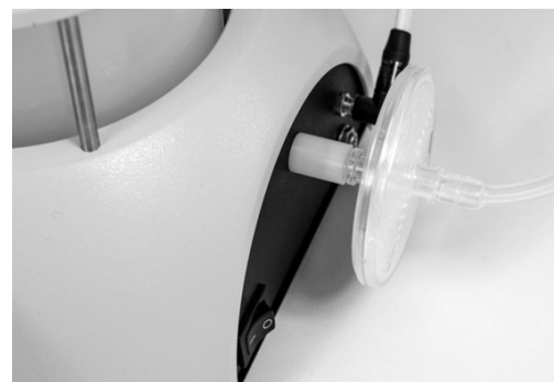
Rückseite mit ON/OFF-Schalter und hydrophobem, mikrobiologischem Filter
