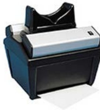
Dunkelkammer CN-6 mit zwei UV-Handlampen und Probeneinschub vorn.
