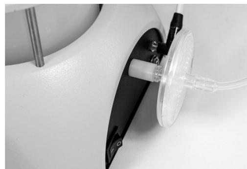
Rückseite mit ON/OFF-Schalter und hydrophobem, mikrobiologischem Filter
