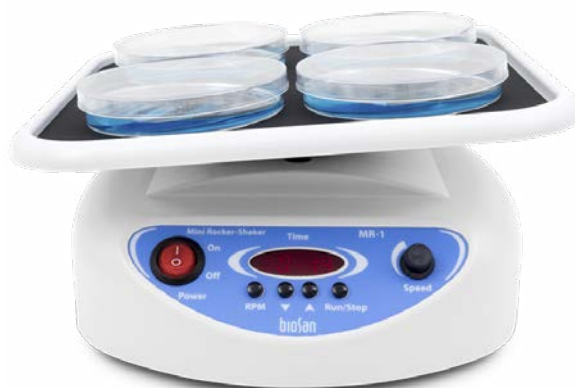
Wipp-Schüttler MR-1 mit Standardplattform
