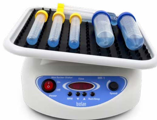
Wipp-Schüttler MR-1 mit noppter PDM-Matte
