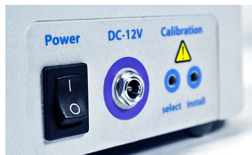
Modell DEN-1B Rückseite mit Kalibriersteuerung
