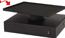
Orbital-Schüttler: 30 U/min, Winkel 2°, max. Beladung: 1.36 kg
