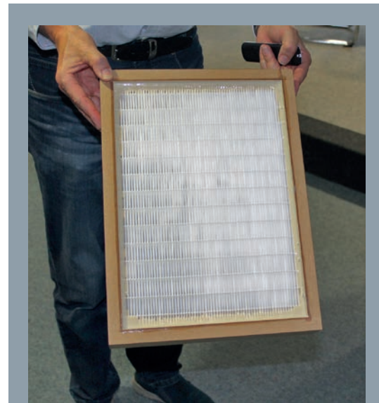
HEPA-Filter, Filterklasse H14 nach EN 1822.
