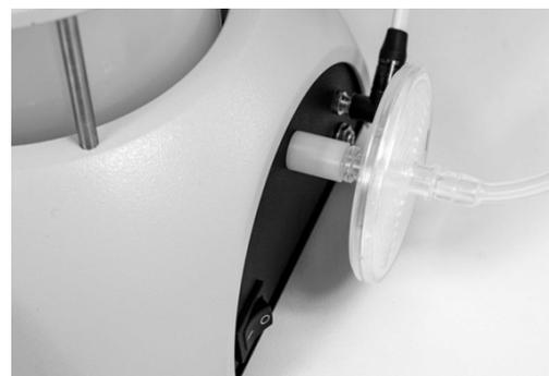
Rückseite mit ON/OFF-Schalter und hydrophobem, mikrobiologischem Filter
