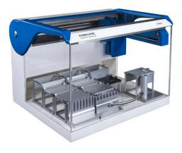
Der Pipettierroboter PIRO bietet bei sehr geringem Platzbedarf, höchste Flexibilität für eine Vielzahl von Liquid-Handling Aufgaben. Ob einfacher Flüssigkeitstransfer oder komplexer PCR-Ansatz — mit der intuitiv zu bedienenden Software sind Ihre Projekte minutenschnell entwickelt und zum Einsatz bereit.
